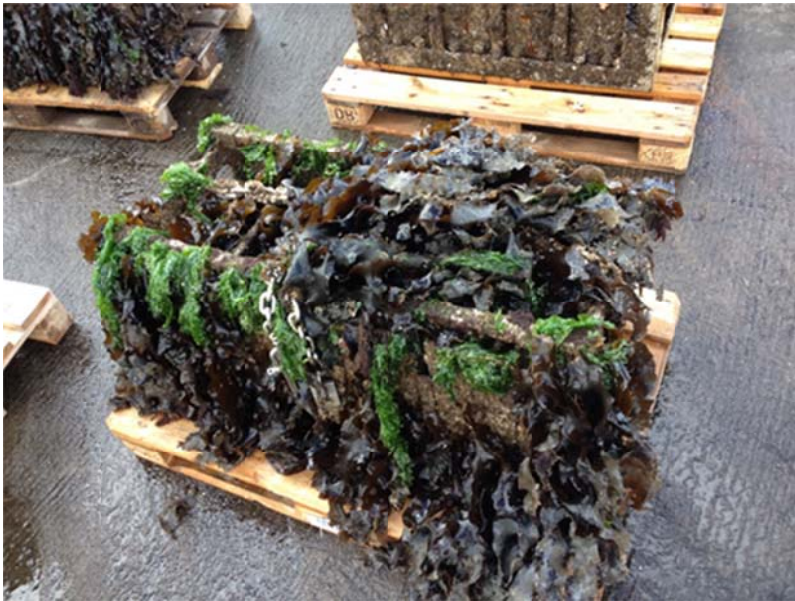
Figur 3: Stålburar med prover vid upptagning efter 15 månader i havet.
